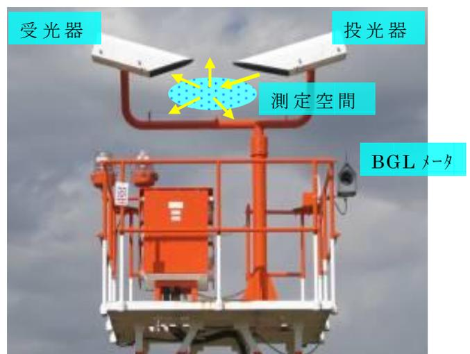
写真 5 前方散乱方式の測定部分
